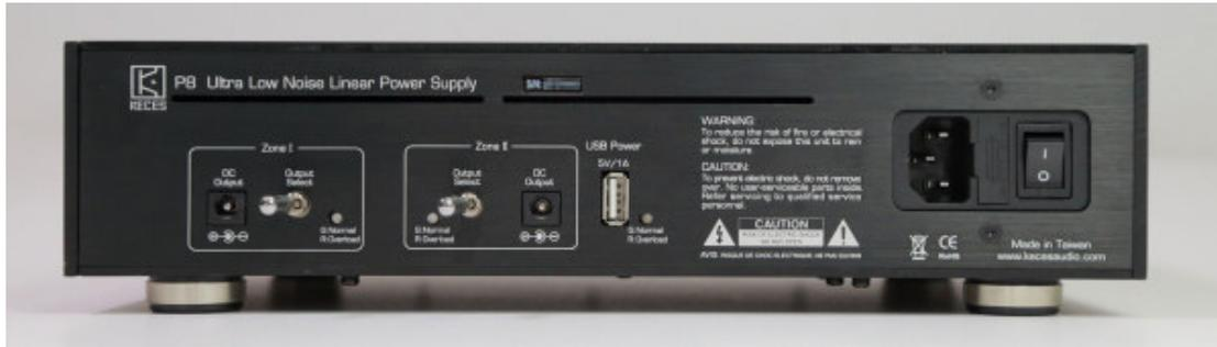
我們先直接看到 P8 的背板。上頭有 Zone I 與 Zone II 兩區，每區各有一個 DC 輸出插孔，插孔旁帶一個搖頭切換開關，可切換該輸出的電壓，再加上 USB 5V 輸出，每台 P8 有三組輸出，可輸出五種電壓。為了避免不小心誤出搖頭開關而改變輸出電壓，傷及器材，這個開關是上了保險的，必須將柄拉起才能扳動，所以不怕誤觸。可是，背板上的印刷字樣沒註明電壓，如何得知現在切換到多少 V 了？那就是面板顯示幕的功能了。P8 面板上有一個橫幅 LED 顯示幕，上頭註明了 Zone I 與 Zone II 的電壓與電流，只要切換背後的開關，面板上顯示的電壓便會跟著變動。所以，P8 正確的使用方法是開電前先不要接背後的輸出，而是開電後看面板確認 Zone I 與 Zone II 輸出的是你要的電壓，然後才把直流電接上器材。
